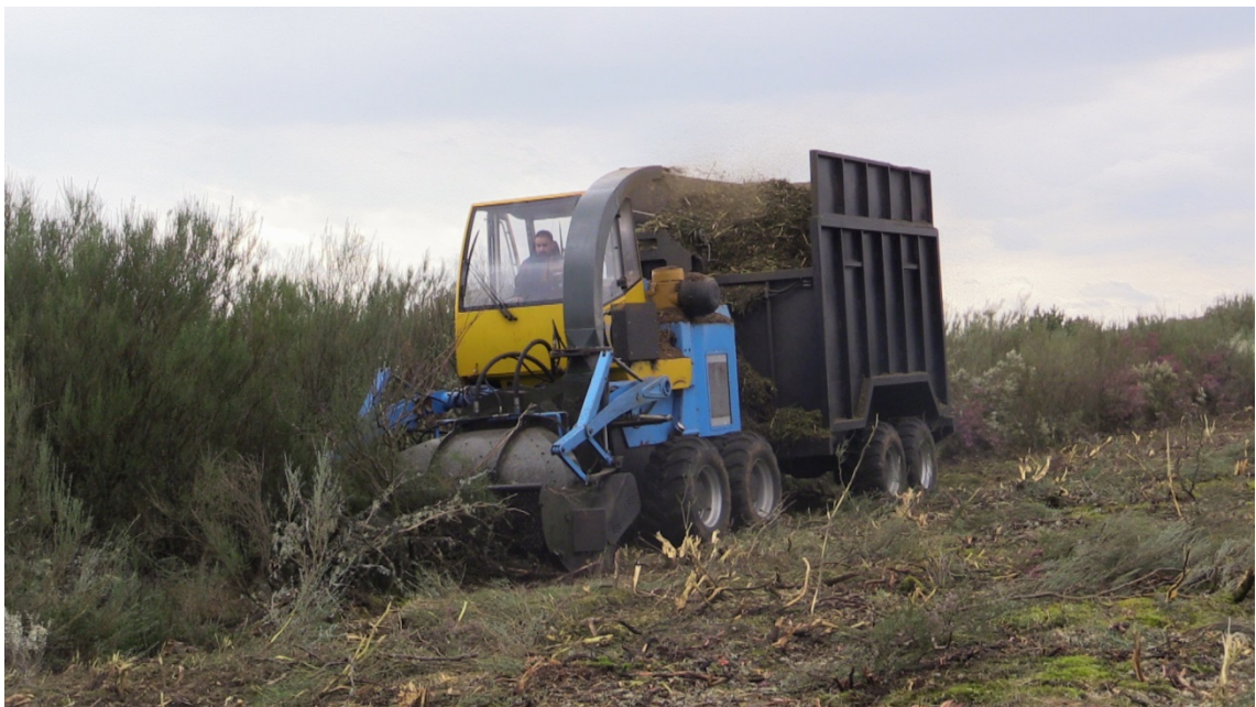
Foto 2: El triturador Retrabilo trabajando en una mezcla de escoba, brezo y jara en Figueruela de Arriba (Zamora)
